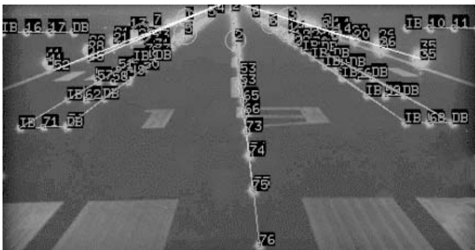
Figura 4. Imagen final segmentada con las ayudas visuales luminosas detectadas y agrupadas en líneas.
